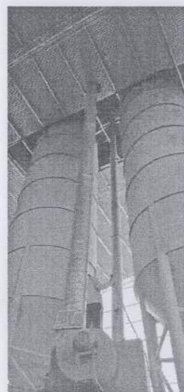
水稳线水泥筒仓工序脉冲布袋除尘器+15m 排气筒
